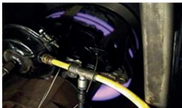
Brzdy při vysokém zatížení dosahují teploty vyšší jak 500 / 600 °C
